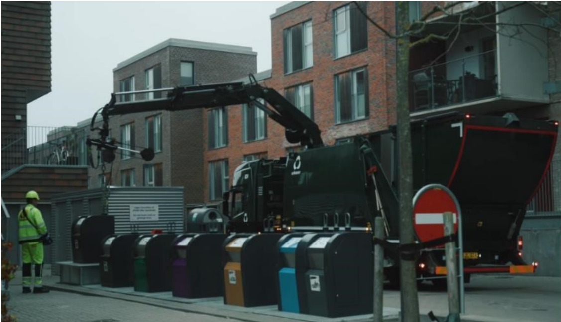
Figura 8. Camión Scania eléctrico con grúa y compactadora eléctricas
